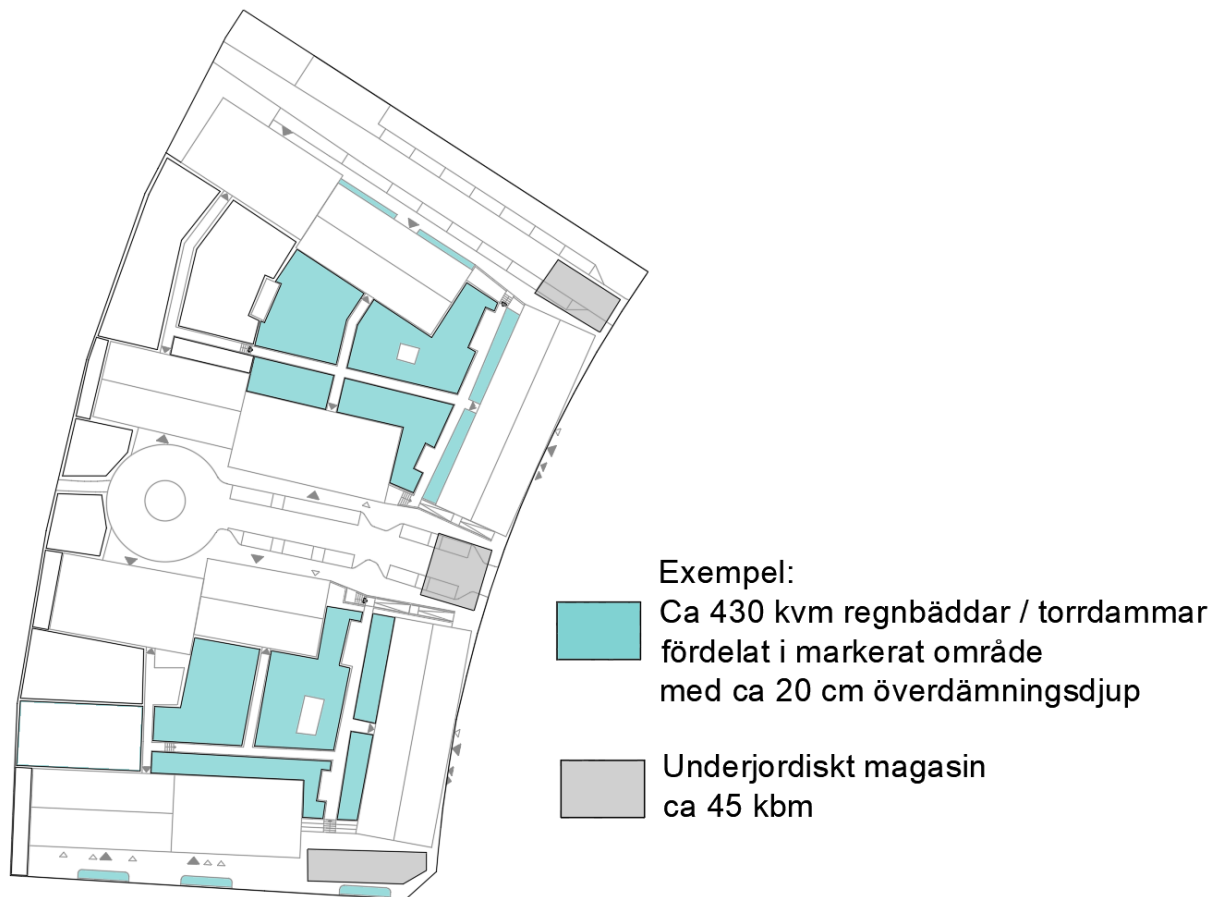
Figur 17 Översikt anläggning av fördröjningsvolym. Regnbäddar / överdämningsytor / torrdammar fördelas relativt jämnt för att ta emot dagvatten från områdets hårdgjorda ytor. Övrig underjordisk fördröjningsvolym anläggs nära servisanslutningar mot gata
